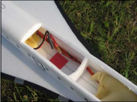
Mit der Akkuposition wird der korrekte Schwerpunkt eingestellt. Ein kleines Stück Klettband reicht zur Befestigung.
